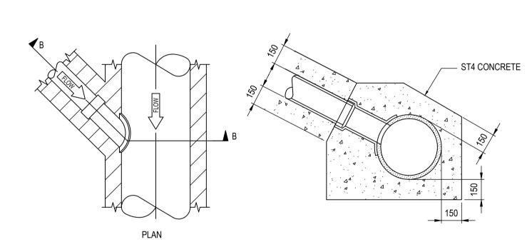
GULLY CONNECTION PLAN CONCRETE SURROUND SCALE - 1:20
